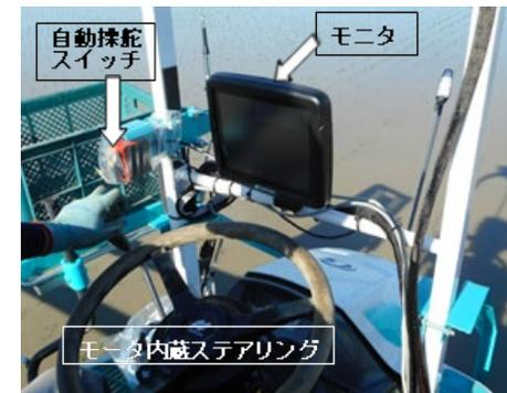
写真 RTKGNSS 自動操舵装置装着田植機
