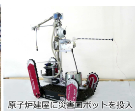
原子炉建屋に災害ロボットを投入
