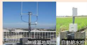
無線基地局 自動給水栓
